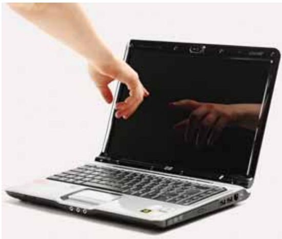
Bild 7 Modernes Notebook mit stark spiegelnder Bildschirmoberfläche.
