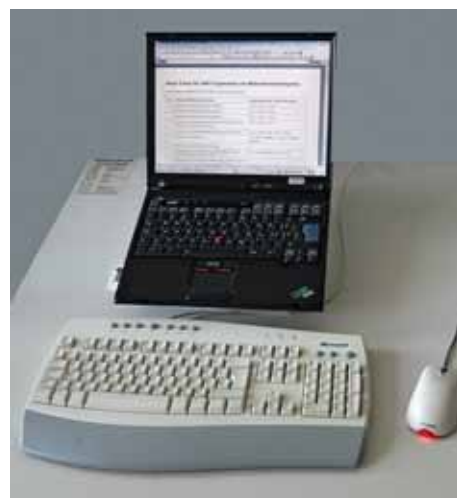
Bild 6 Notebook auf einer Dockingstation mit separater Tastatur und Maus.
